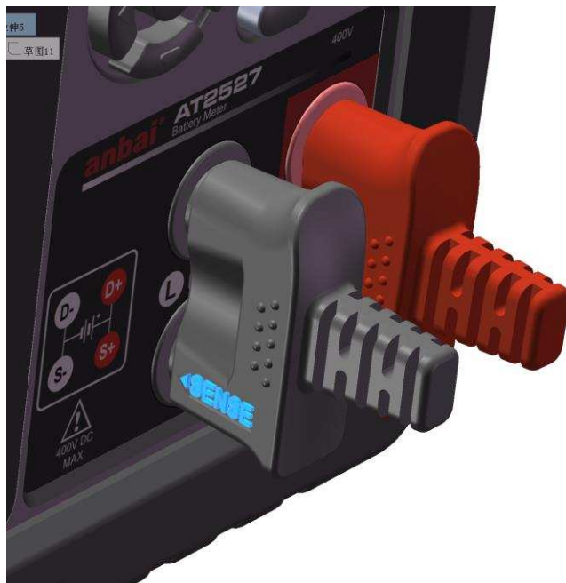
测试线的连接方法
