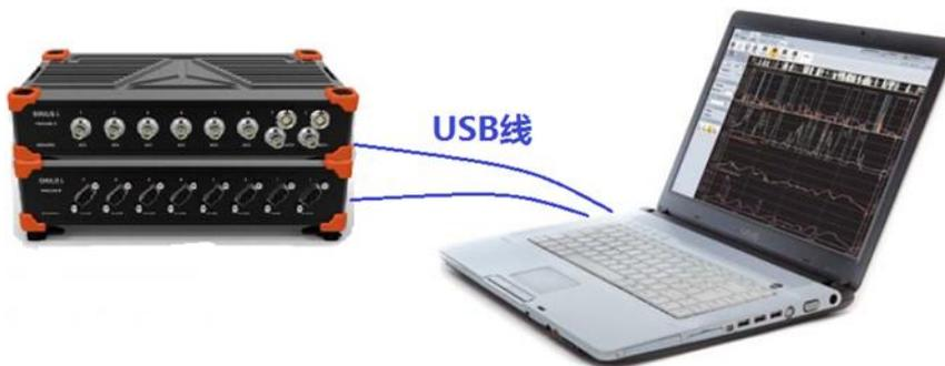
图 154、两台 SIRIUS 数据采集模块同步使用时与计算机部分的连接
