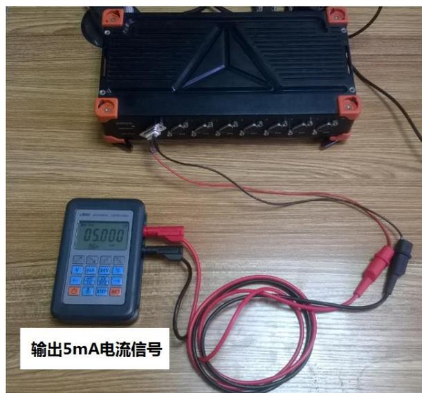
图 13、使用采样电阻测量电流（无供电）
