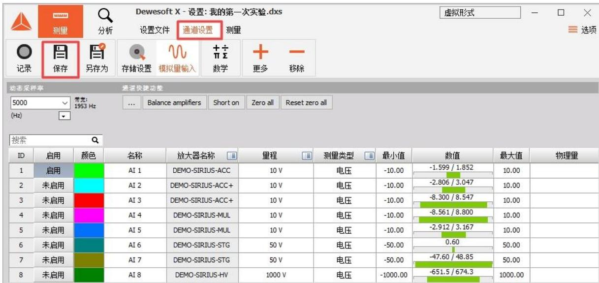
图 117、保存测量显示界面的设置
