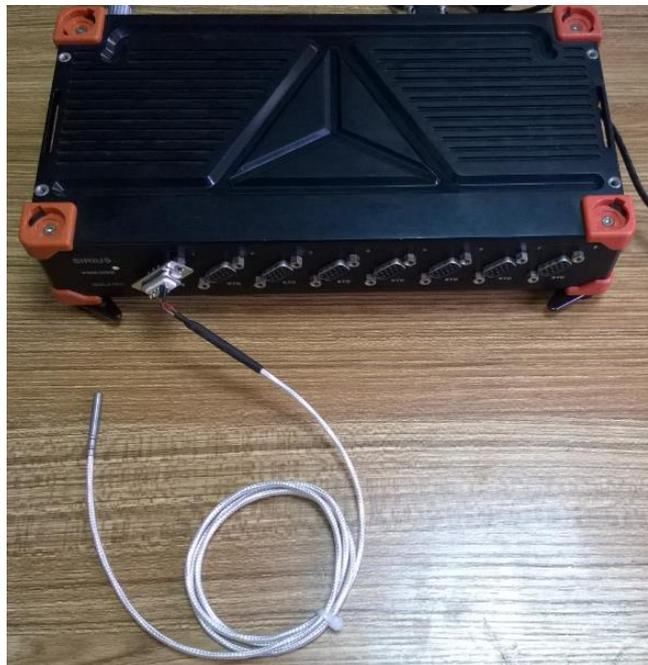
图 28、4 线制铂电阻与 SIRIUSi 8xSTG 模块的连接
