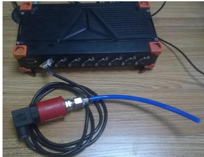
图 18、2 线制 4~20mA 输出型压力传感器连接 SIRIUSi 8xSTG 模块
