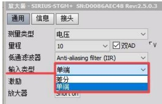
图 64、电压输入类型
