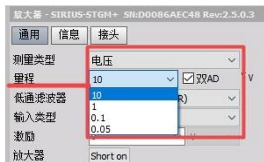
图 62、选择电压量程
