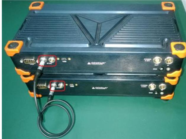
图 153、两台 SIRIUS 数据采集模块同步使用时同步线的连接方法
