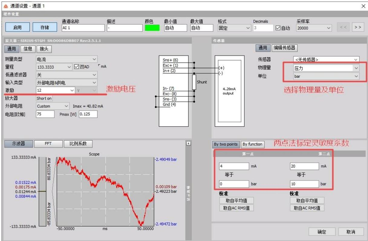
图 20、测量电流（2 线制 4~20mA 输出，需回路供电）通道设置界面
