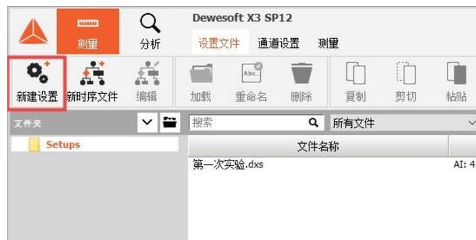
图 55、新建设置 (New Setup) 按钮
