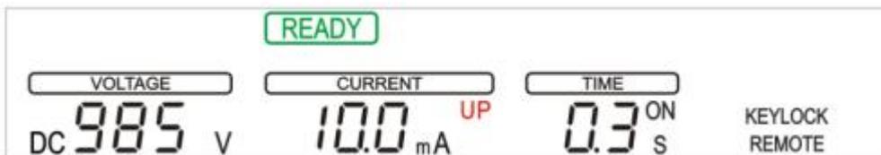
注：KEYLOCK 是按键是否锁住指示标志，按键锁住 KEYLOCK 点亮，否则反之；REMOTE 是前面板遥控高压棒是否接入指示标志，接入则 REMOTE 点亮，否则反之。
