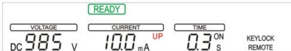
如果按“START”开关，本仪器即开始进行测试。如果想进行参数修改则拔掉遥控高压棒并且解锁按键（先按住“EXIT KEYLOCK”键不放，再按一下“SET”键），接着再按“SET”键，本仪器就立即进入参数设定模式，可以进行参数设定。
