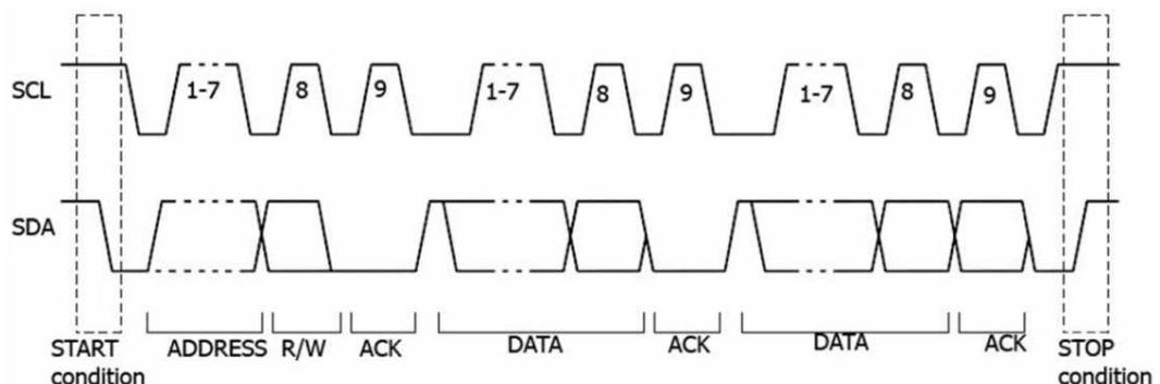
图 8.26 I2C 协议时序图
