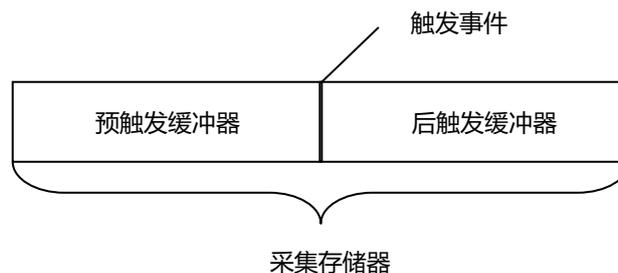
图 8.1 采集存储器的示意图
