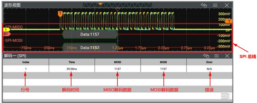
图 18.12 SPI 解码事件表
