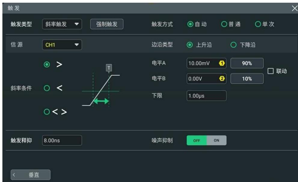
图 8.7 斜率触发配置菜单
