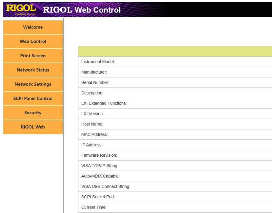
4. 点击左侧的 **Web Control** 可进入仪器控制界面，可使用鼠标实时远程控制仪器，效果与在仪器屏幕上直接进行触控操作基本一致。
