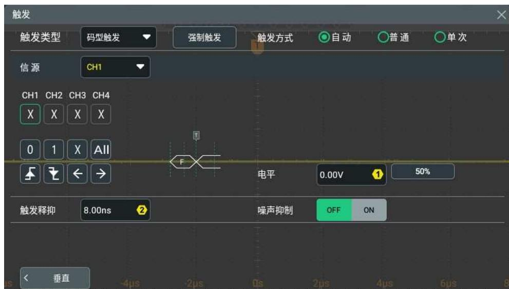
图 8.10 码型触发配置菜单
