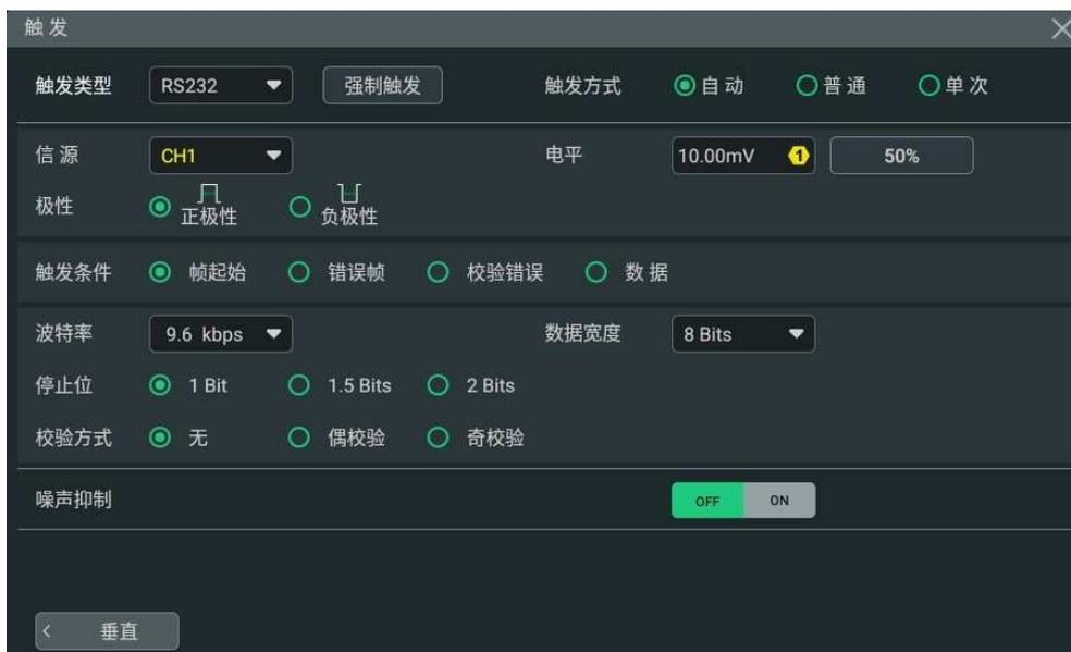
图 8.25 RS232 触发类型配置菜单
