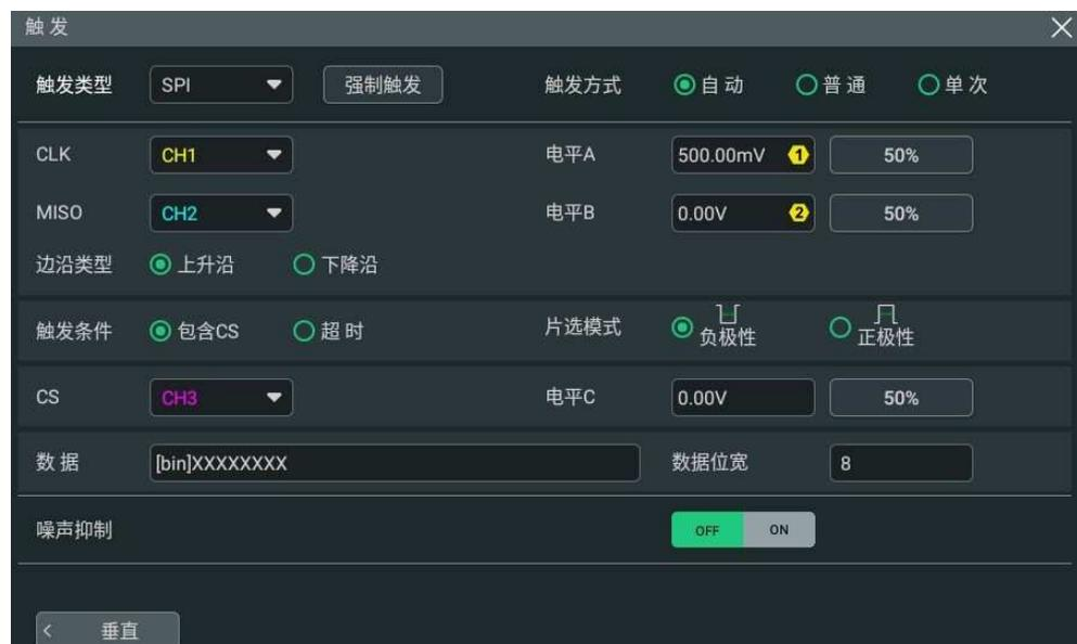
图 8.31 SPI 触发配置菜单
