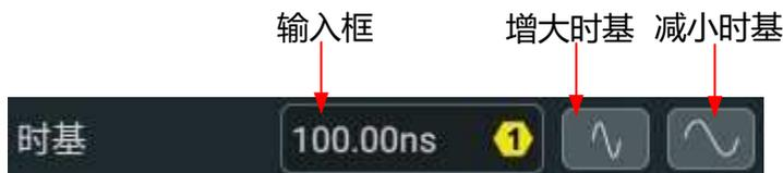
在 **水平** 系统菜单中，点击 **微调** 项的按钮，选择打开 (ON) 微调或关闭 (OFF) 微调。您可以通过按下前面板右侧的 **水平**
