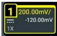
通道状态标签中显示的信息与当前通道设置有关（与通道的开/关状态无关）。打开通道后，根据输入信号调整垂直档位、水平时基、触发方式以及触发电平等参数，使显示的波形易于观察和测量。
