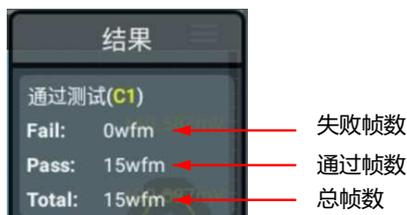
点击“通过测试”测量结果标签，弹出子菜单，您可进行如下操作：
