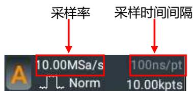
模拟通道的采样率和当前操作的通道模式相关。本示波器单通道模式实时采样率最高为 4 GSa/s，双通道模式实时采样率最高为 2 GSa/s，全通道模式实时采样率最高为 1 GSa/s。
