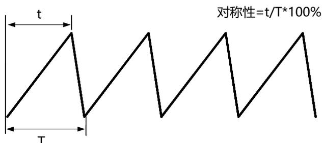
点击 **对称性** 项的输入框，通过弹出的虚拟数字键盘设置锯齿波对称性；也可以旋转对应的多功能旋钮设置此值。对称性的可设置范围为 0% 至 100%，默认值为 50%。
