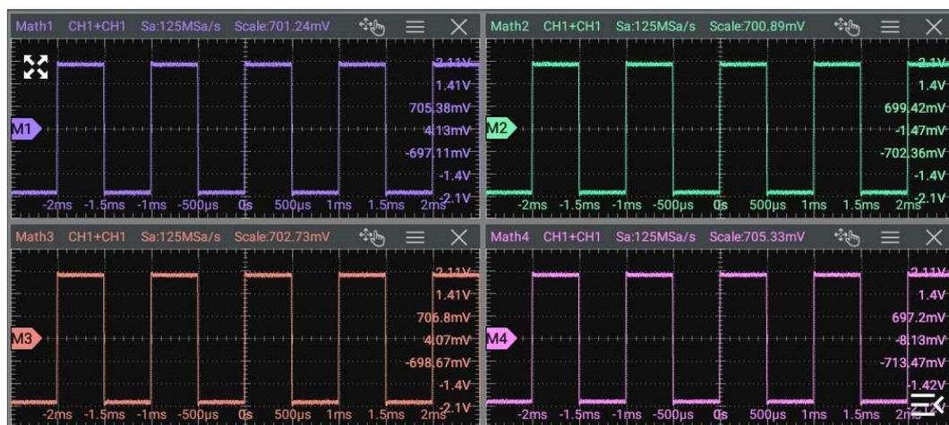
图 9.2 运算结果的波形显示窗口
