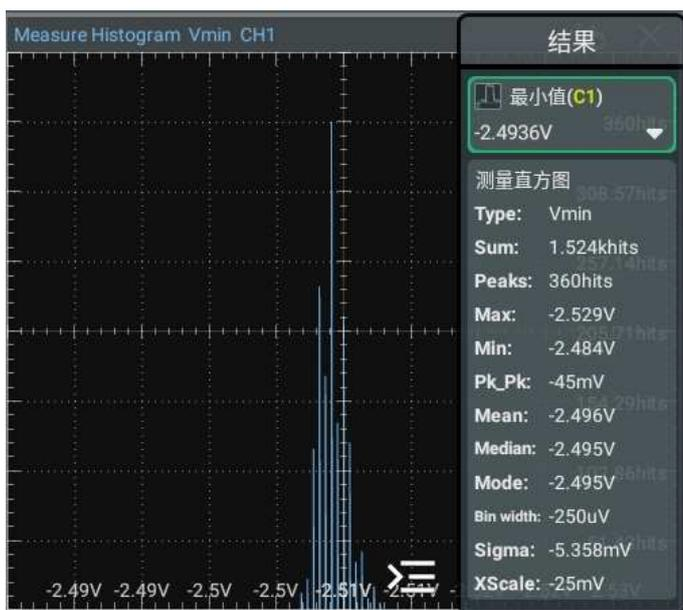
打开测量直方图功能后，请参考 [选择测量参数](#) 添加新的测量参数，新添加的测量参数将作为测量直方图的测量项。您也可以在屏幕右侧结果显示窗口中，点击已添加的测量参数（如“峰值”、“最小值”）结果标签，切换测量直方图功能的测量项。
