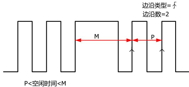
图 8.22 第 N 边沿触发示意图
