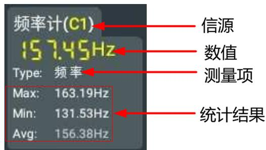
您可点击“结果”菜单中的“频率计”，在弹出的子菜单中选择**统计复位**、**清除测量**和**测量设置**。
