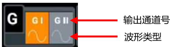
当 AFG 功能为启动状态时，在 AFG 设置菜单中点击 **输出** 项开关、点击或向下拖动屏幕下方的 AFG 标签，都可关闭该通道的输出并退出配置菜单。
