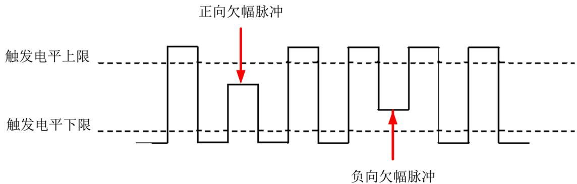
图 8.15 欠幅脉冲触发示意图
