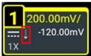
关闭波形反相时，波形正常显示；打开波形反相时，波形电压值被反相，如下图所示。打开波形反相还将会改变数学运算、波形测量等操作的结果。
