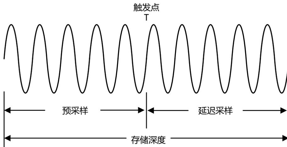
图 7.2 存储深度示意图
