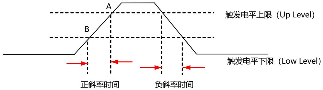
图 8.6 正斜率时间/负斜率时间
