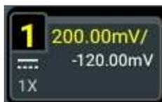
点击屏幕下方的通道状态标签，或按前面板右侧按钮 **1**，可激活通道 CH1。您也可在垂直系统菜单中选中 **CH1** 激活通道。
