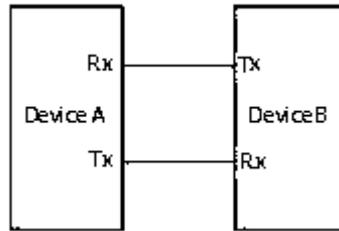
图 18.4 RS232 串行总线示意图
