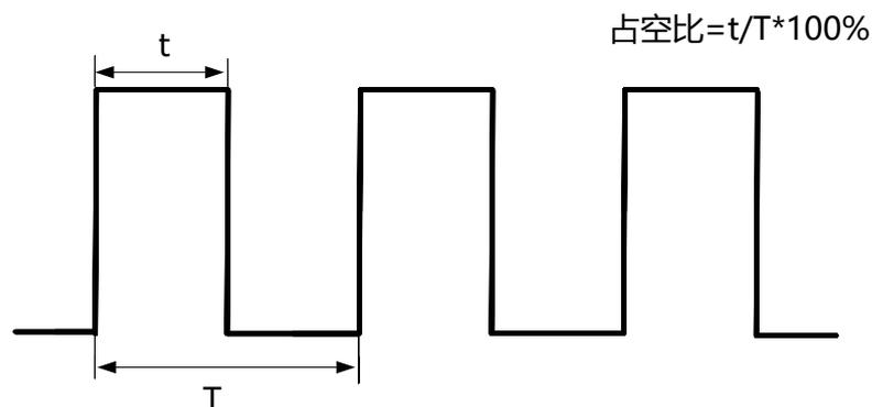
点击 **方波占空比** 项的输入框, 通过弹出的虚拟数字键盘设置方波的占空比; 也可以旋转对应的多功能旋钮设置此值。方波空比的可选范围为 1%~99%, 默认值为 50%, 实际可设置的最大最小值受输出频率限制。
