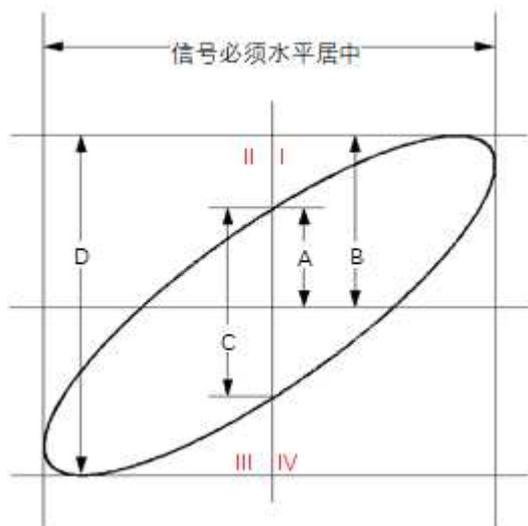
图 7.4 相位差的测量原理图
