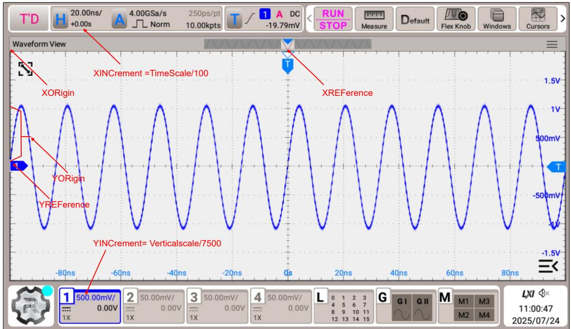
图 3.15 NORMAL 模式下的参数定义
