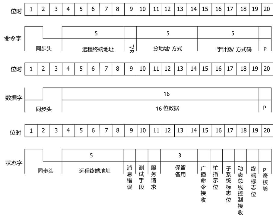
图 3.14 1553B 总线命令字、数据字和状态字格式图
