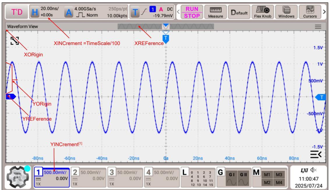
图 3.16 RAW 模式下的参数定义
