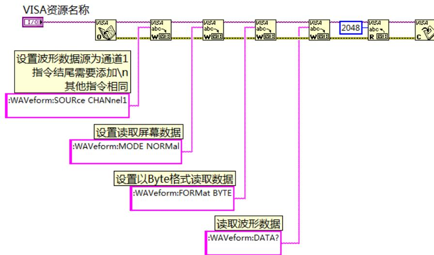
6. 读取的数据格式为 TMC 头+波形数据点+结束符。TMC 头为#NXXXXXX 的形式，#为 TMC 规定的头标志符，N 表示后面含有 N 个字节，以 ASCII 字符的形式描述波形数据点的长度，结束符用于表示通讯的终止。例如，一次读取的数据为：#9000001000XXXX 表示 9 个字节描述数据的长度，000001000 表示波形数据的长度，即 1000 字节。通过以下框图程序获取 TMC 头所占的字节数，跳过 TMC 头，去掉波形数据结尾的结束符，并将波形数据转换为字节数据在波形图控件上显示。
