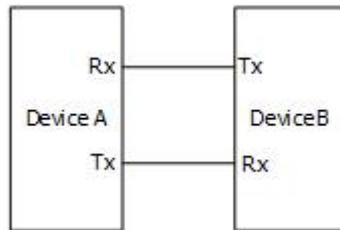
图 3.2 RS232 串行总线示意图
