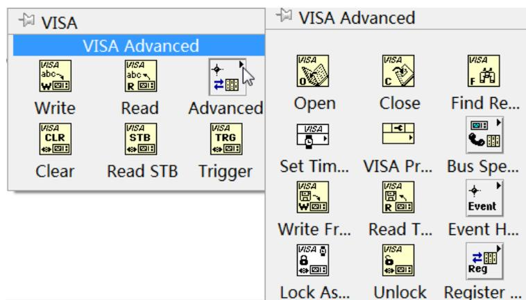
4. 将 VISA 资源名和 VISA Open 相连，将所有函数的 VISA 资源名称输出和 VISA 资源名称连接，错误输出和错误输入连接，如下图所示：
