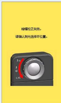
暗幅校正过程中，由于测光选择环②的位置发生变化，未能正常执行。
