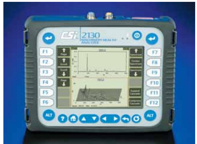
应用瀑布图能够捕获设备在启动、停机、或在一段时间内的振动,屏幕的上部为单独显示的频谱图,屏幕的下半部为瀑布图。
