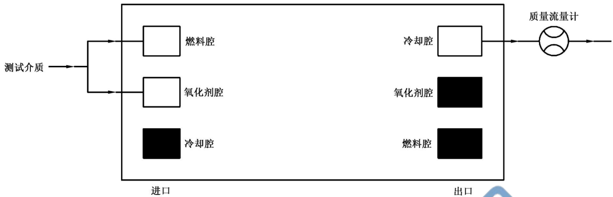
图 7 燃料腔、氧化剂腔到冷却腔窜漏测试示意图
