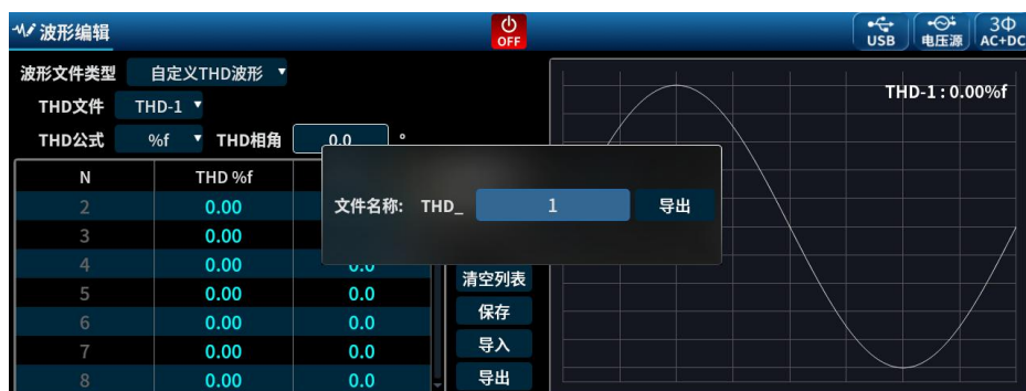
图 6-24 自定义波形导出示例图
