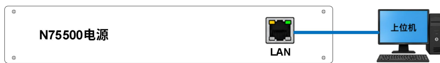
图 4-13 单机连接示意图
