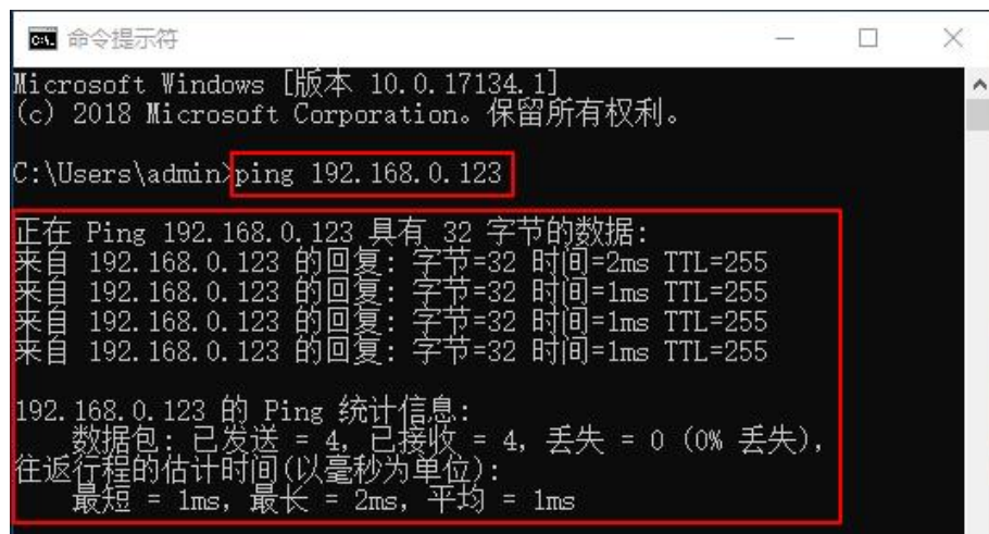
图 8-12 测试通信正常示意图
