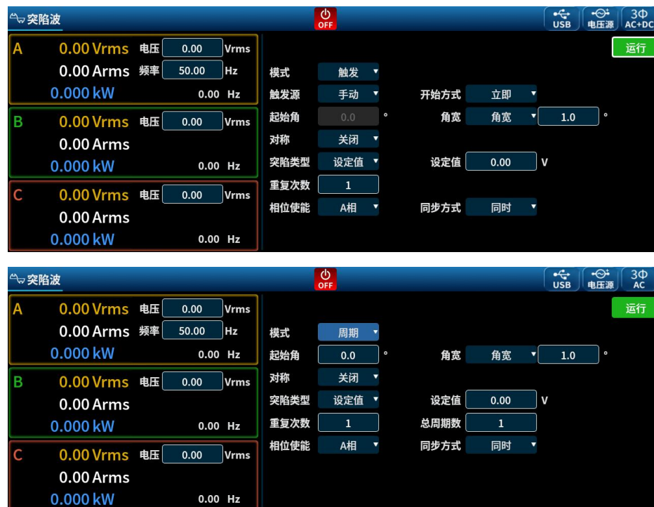
图 6-29 突陷波模拟界面
