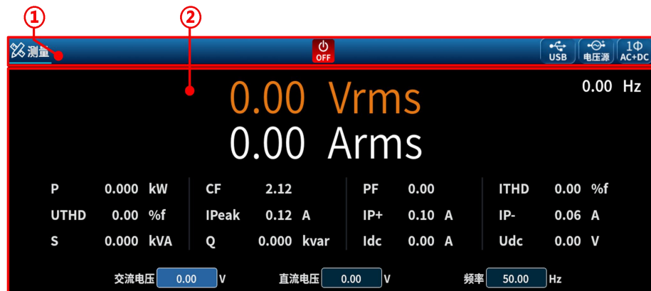
图 5-1 单相模式下测量功能界面图
