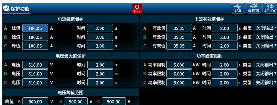
图 6-33 关闭输出模式保护功能界面图
