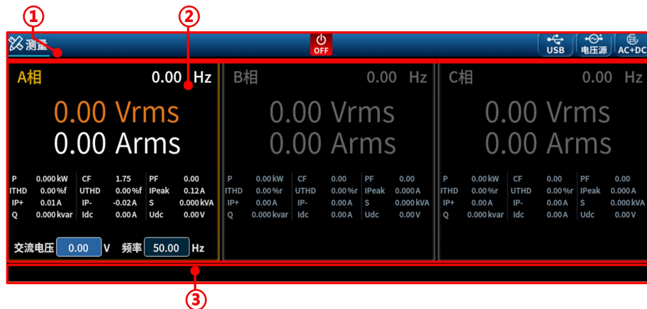
图 5-4 分相模式下测量功能界面图
